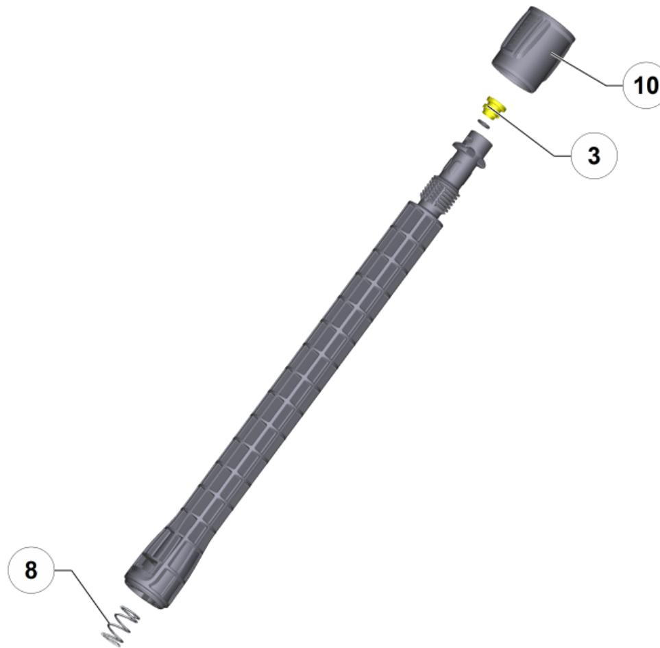
**1 1-СТУПЕНЧАТАЯ УДЛИНИТЕЛЬНАЯ ТРУБКА 0,4 М (2.643-240.0)**
