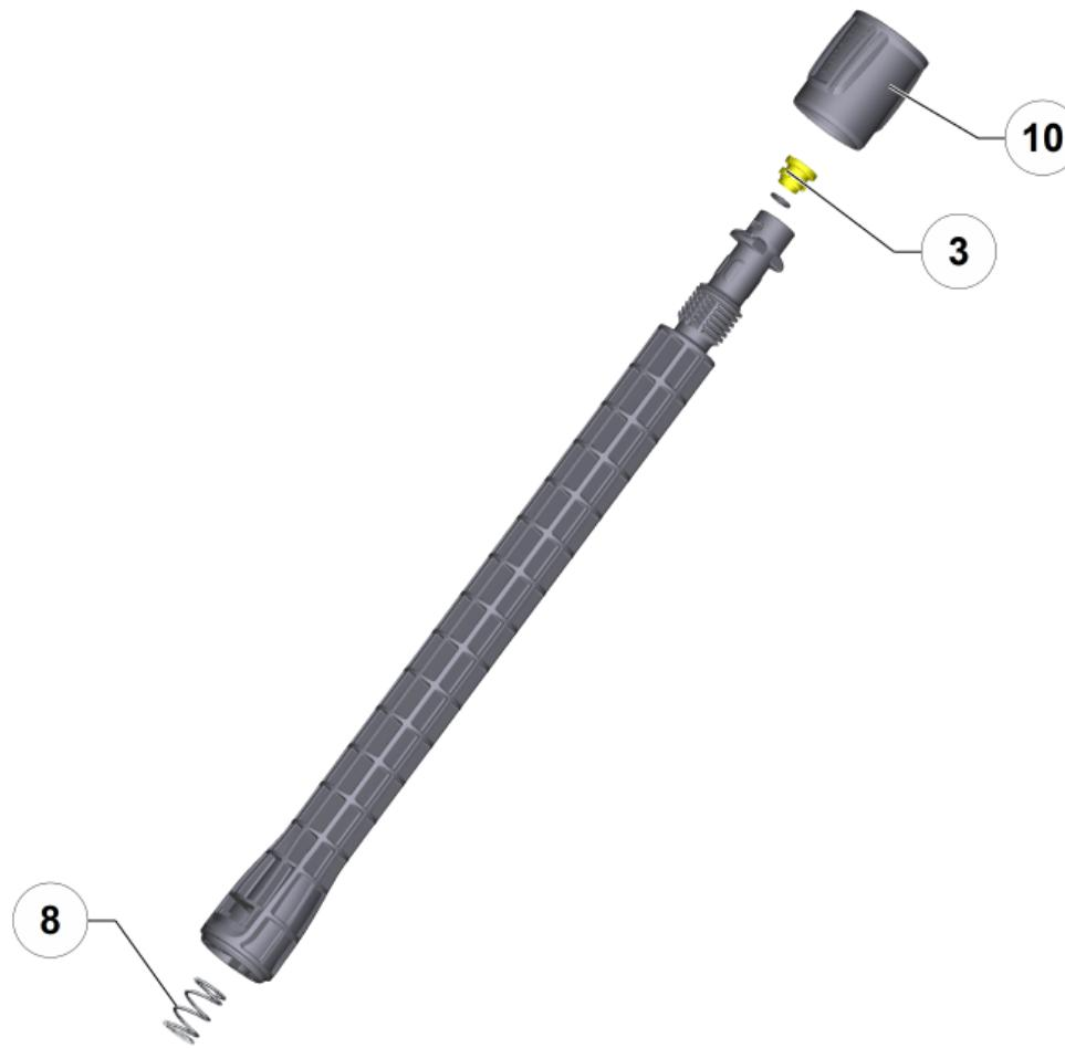
**1 1-СТУПЕНЧАТАЯ УДЛИНИТЕЛЬНАЯ ТРУБКА 0,4 М (2.643-240.0)**
